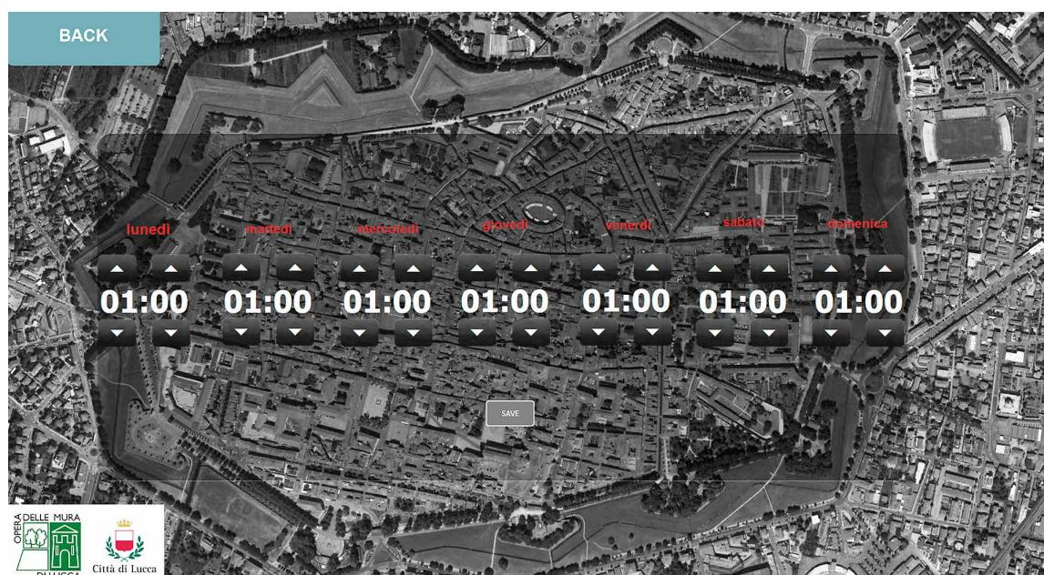
Il sistema di controllo centralizzato consente la programmazione dei tempi di funzionamento e il monitoraggio dei guasti sulle linee, ottimizzando i tempi di utilizzo dell'impianto.
